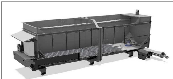
Figure 27 : Incorporateur de type Big Mix
