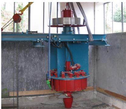
Figure 13 : Photo montrant une turbine Kaplan en configuration fronto-spirale
