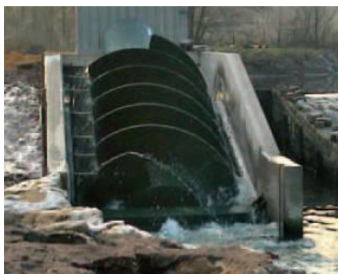
Figure 16 : Représentation de la vis hydrodynamique (source Ritz-Atro)
