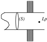
Si le niveau de pression sonore *L*p est mesuré dans une gaine ou au droit d'une ouverture, la surface *S* à prendre en considération est la section de la gaine ou celle de l'ouverture (par exemple : porte)
