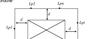
Le calcul de la puissance sonore de ce type de source fait l'objet de la norme NF S 31-207 (ou ISO 3746).
