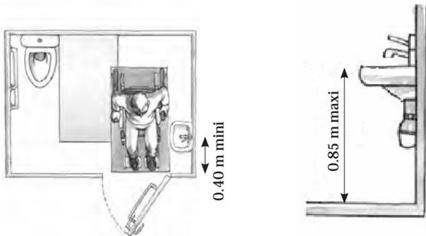
Le robinet doit être situé à au moins 0.40 m d'un angle rentrant.
